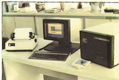
Ο ΕΡΜΗΣ με μονάδα σκληρού δίσκου (5 Fix/5 Removable). Πάνω στο τραπέζι διακρίνεται η κασέτα σκληρού δίσκου των 5 Mbytes.
